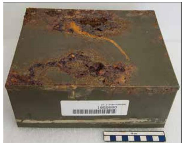
Foto 2: Stark korrodierte Metallschachtel
