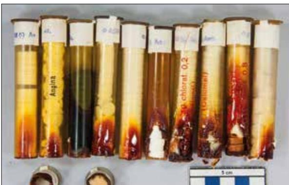
Foto 3: Das Medikament Hexamin zersetzte über die Jahre seine eigene Hülse vollständig und beschädigte angrenzende Hülsen. Zusätzlich sind unterschiedliche Vergilbungsgrade bei den Hülsen zu beobachten.
