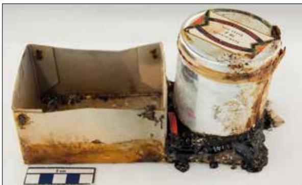
Foto 1: Wegen der ausgelaufene Substanz der Blechdose verklebten die umliegenden Materialien miteinander und die Metallschachtel, in der sie aufbewahrt wurde, korrodierte stark (siehe Foto 3).
