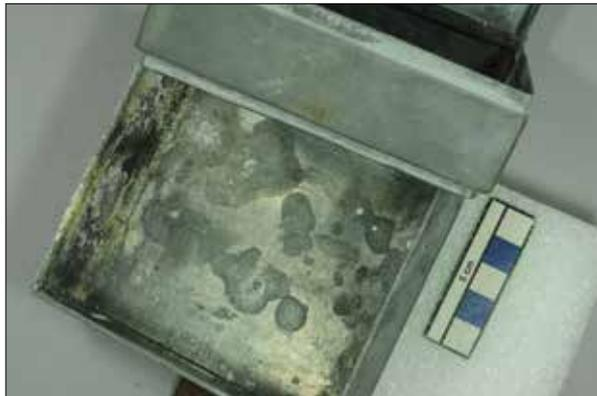
Foto 7: Metallbüchse für Reinigungsmaterial, Korrosionsschaden.
