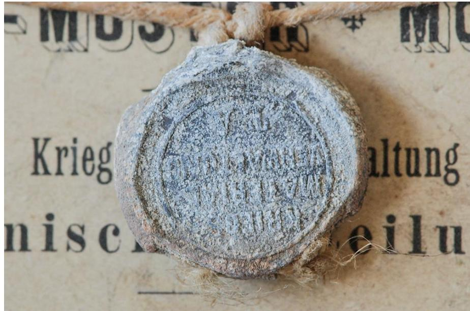
**Bildkommentar:** Bleisiegel mit Korrosionsprodukten überzogen
