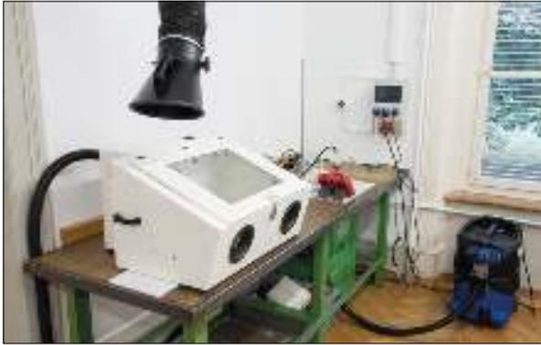
*Einrichtung im Atelier in Thun mit Sicherheitsbox und Staubsauger Staubklasse H.*
