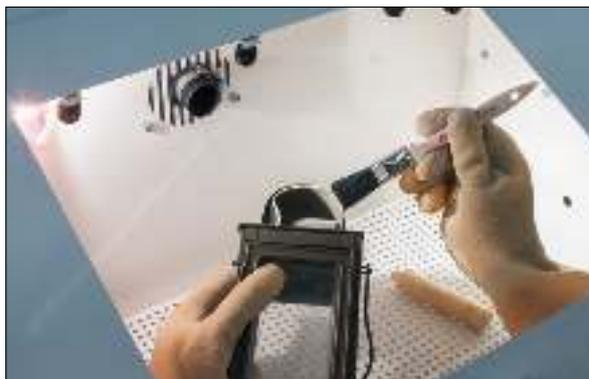
*Entstaubung des Objekts in einer Sicherheitsbox (mit Spezial-Staubsauger Klasse H = genehmigt für Asbest). Die Sicherheitsbox verhindert, dass der Mitarbeitende in direkten Kontakt mit Asbeststaub gerät.*
