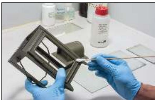
*Reinigung/Dekontaminierung des Objektes mit destilliertem Wasser, Isopropanol und/oder Aceton (je nach Material; unter Verwendung eines Baumwollstäbchens). Der Einsatz dieser Lösemittel erfordert aus Sicherheitsgründen das Tragen von Handschuhe und die Verwendung von Absaugsystemen.*
