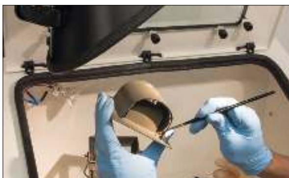
*Befestigung der verbliebenen losen oder ungesicherten Asbeststellen (mit Paraloid®B72). Paraloid B72 wird seit den 1950er Jahren in der Restaurierung eingesetzt. Es gilt als das meistgeprüfte und stabilste Harz, welches im Bereich Konservierung-Restaurierung verwendet wird.*
